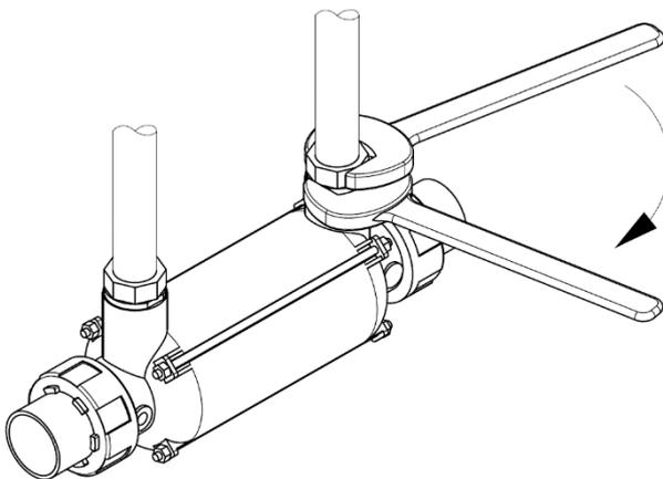
Damit sich der Edelstahlnippel nicht vom Wärmetauscher-Gehäuse und vom Wellrohrwendel löst und Undichtigkeiten entstehen, oder damit bei zu viel Druck keine Risse am Kunststoffgehäuse entstehen, blockieren Sie den Edelstahlnippel mit einem zweiten Schlüssel oder einer Zange.
